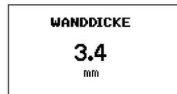
Um die Rohrwandstärke zu bestimmen, ist optional ein Wanddickensensor erhältlich. Schließen Sie diesen am Sensoreingang an und wählen **Schnellstart – Messung starten**.
