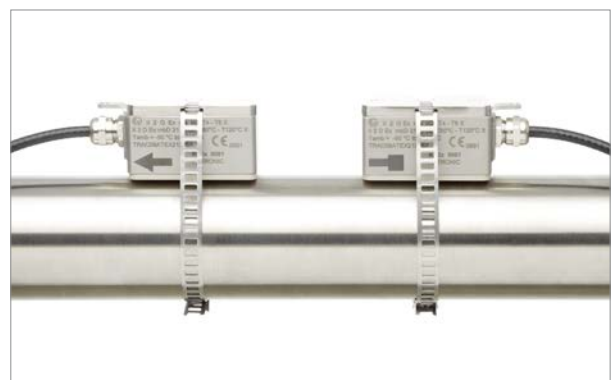
Wandlerpaar mit Metallbändern am Rohr befestigt
