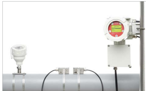
ATEX-PT100-Temperatursensor, montiert am Rohr mit KATflow 170 und Ex-Sensoren
