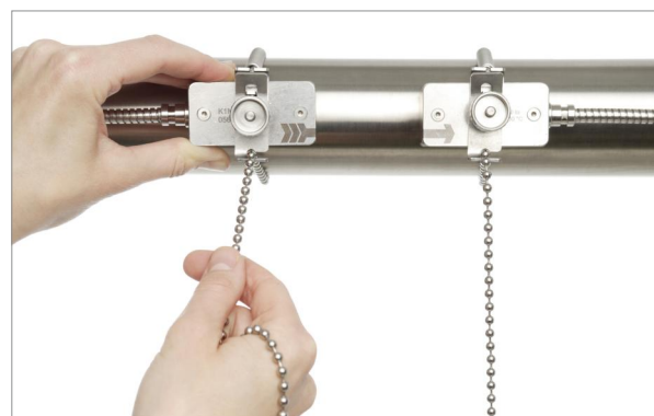
Mit Ketten und Clips angeklebte Sensoren
