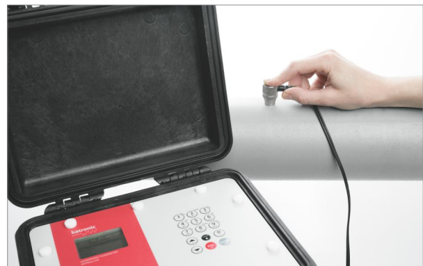
Wanddickensensor NT und KATflow 210 im Einsatz
